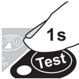
Der Drehschalter (8) ist in Position **ARM**. Drücken Sie jetzt den Taster **TEST** (10) für etwa 1 Sekunde. Der Notsender RT-B77 HELB startet eine Selbsttestroutine. Dabei werden eine Anzahl elektronische Betriebsparameter und der Zustand der Batterien überprüft.
